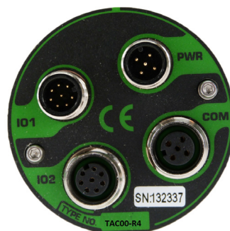
Erweiterungsmodul MAC00-Rx mit 4 M12-Steckern zum Einbau in einen MAC Servomotor
